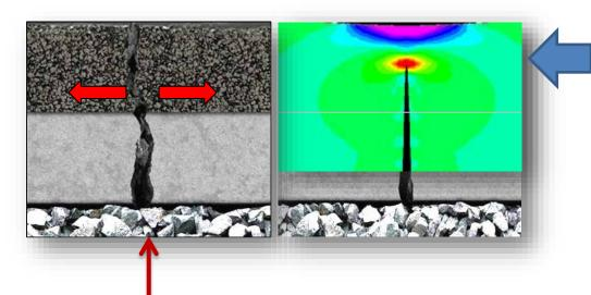
Source 1: Montestruque G. E., 2002, Contribuição para a Ela-boração de Método de Projeto de Restauração de Pavimentos Asfálticos Utilizando Geossintéticos em Sistemas Anti-Reflexão de Trincas (Contribution to the preparation of a method of a project for rehabilitation of asphaltic pavements using geosynthetics on anti-reflective crack systems). Doctor's Thesis, Technological Institute of Aeronautics, São José dos Campos, Brazil.
